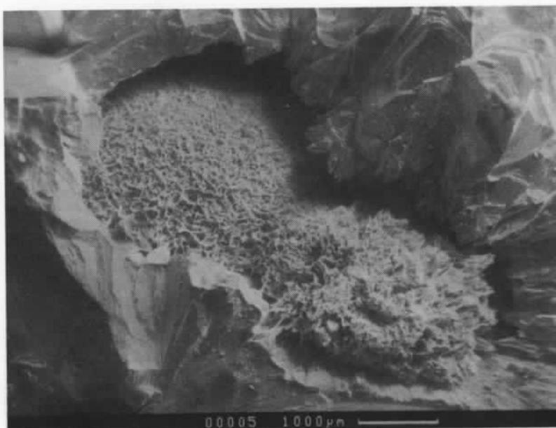
Obr. 3. SEM mikrofoto ukazující kulovité a drobně jehlicovité agregáty todorokitu
