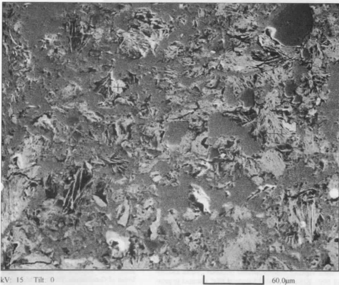
Obr. 2. Jiná mikrofotografie z téhož vzorku černé kůry, leštěný výbrus, SEM. Kostrovité krystaly odpovídají rodochrozitu
