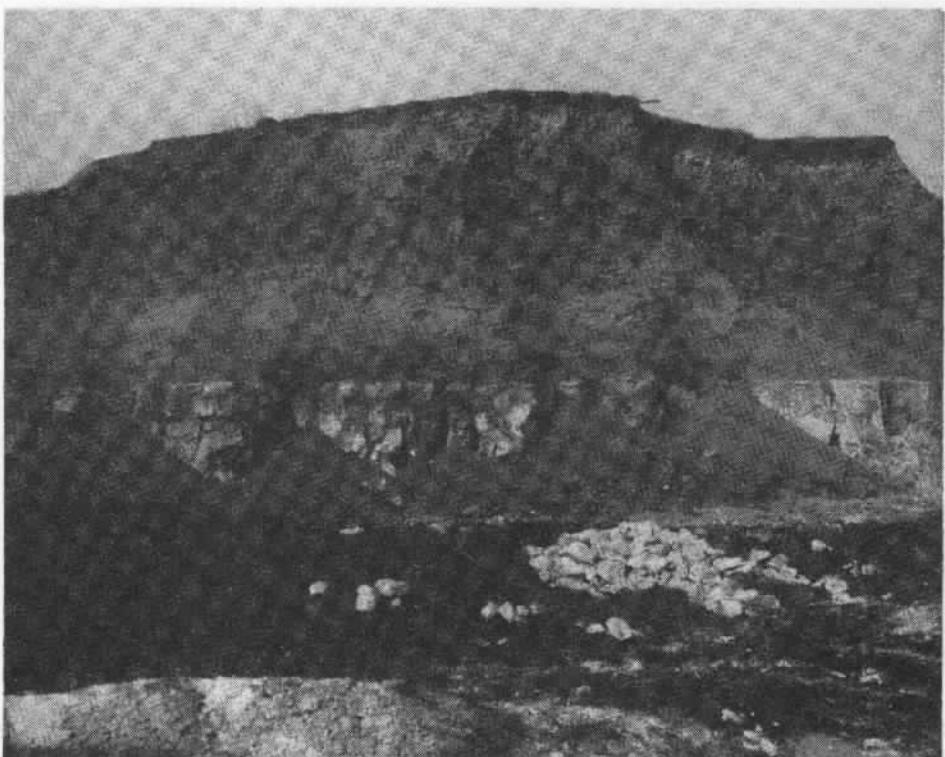
Foto 2. Lom na návrší Vrbka sv. nad Skršním. Naspodu těžená lavice dinasového křemence, po ostrém rozhraní v jejím nadloží bentonitizované tufity a rozložený bentonitizovaný čedičový příkrov
