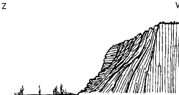
Obr. 2. Schematický náčrt ilustrující přičinu změny orientace sloupcovitosti v části heřmanického lomu jako důsledku geotechnických procesů
