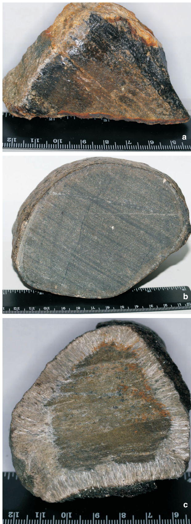
Obr. 7. Porovnání tří stupňů přeměn původního jemnozrného dunitu: a – s páskovanou stavbou, b – se slabší přeměnou serpentinizací, reliktním olivínem a antofylitovým tenkým lemem, c – silně serpentinizovaný úlomek se silným antofylitovým lemem. Páskovaná stavba zůstává zachována u všech úlomků (a, b – Čkyně, c – Sudoměřice).
