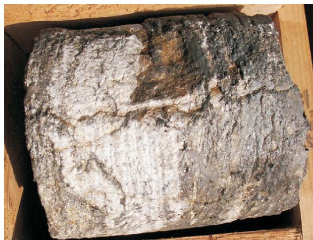
Obr. 1. Vrtné jádro se zkoumaným vzorkem grafitické pararuly.
