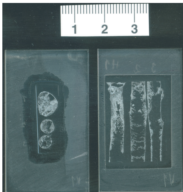
Obr. 2. Stavba silnostěnného symetrického brčka typu I. Vpravo podélné řezy a vlevo příčné řezy v různých částech brčka. Měřítko je v centimetrech.
