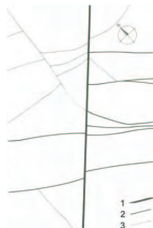
Obr. 4. Puklinové systémy v korycanských pískovcích (zobrazení podle obr. 3). 1 – pukliny 1. řádu, 2 – pukliny 2. řádu, 3 – pukliny 3. řádu.
