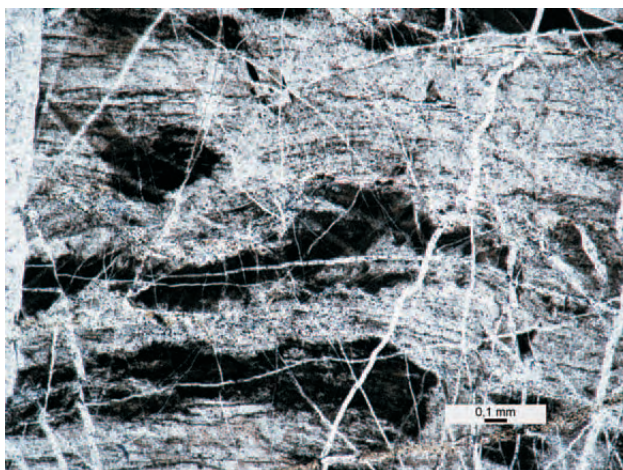
Obr. 3. Mikrofotografie silicitu Vraní skály s původními náznaky laminace a křemennými žilkami.
