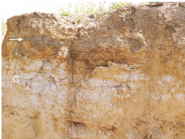
Obr. 4. Odkryv ve výkopu s vrstvou slepence (šipka) ve svrchní části celku C. Výška stěny je asi 1 m.
