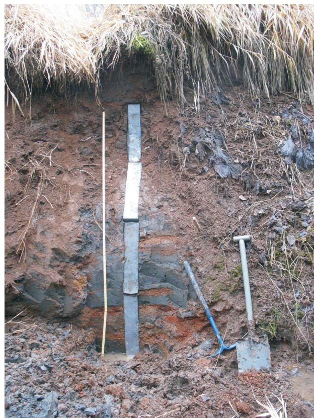
Obr. 4. Způsob odběru sedimentu do plechových krabic o rozměrech 0,50 × 0,10 × 0,10 m. Foto P. Havlíček, 2012 / Fig. 4. Method of sediment sampling into metal boxes of 0.50 × 0.10 × 0.10 m. Photo by P. Havlíček, 2012.
