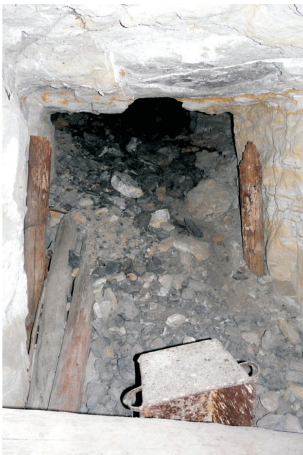
Obr. 2. Uhelné jílovce v ústí štoly. Jižní svah návrší Pravda s. od Doušovic. Foto J. Valečka.
