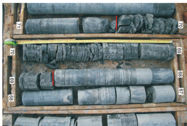
Obr. 3. Poloha silně rozpadavého vápnitěho prachovitěho jílovce teplického souvrství v metráži 68,80–70,40 m (vyznačeno červeně). Na křivce obsahu kalciumkarbonátu (obr. 2) se tato poloha vyznačuje jeho minimálním obsahem. Vrt V 800. Foto S. Čech.
