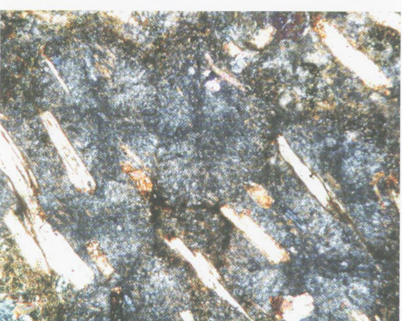
1. Sférolitická struktura minety, intrudující do sedimentů svrchního proterozoika na lokalitě Skalka u Příbrami. Mikrofotografie a) v polarizovaném světle, b) ve zkřížených nikolech,  $\times 25$ .
