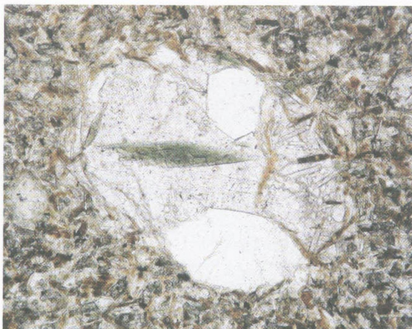
1. Struktura olivín-klinopyroxenového kersantitu s pseudomorfózami po fenokrystech olivínu a ocellárním útvarem s hojným amfibolem (uprostřed); okrajová partie zonální žíly od Dobříše. Mikrofotografie v polarizovaném světle,  $\times 25$ .
