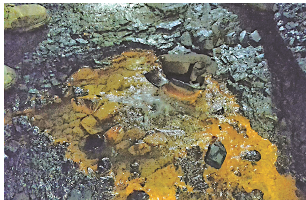
Obr. 5. Přeliv vzpěněné kyselky z uťaté pažnice vrtu JZ 163. Foto P. Urban.
