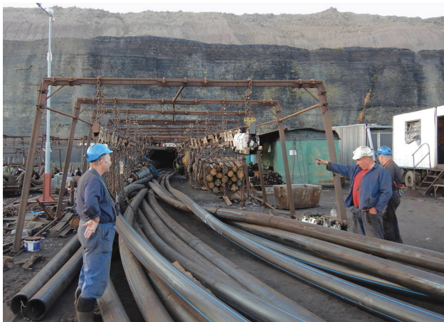
Obr. 1. Ústí západního otvirkového překopu hlubinné těžby v lomu ČSA. Před ústím leží vytažené odvodňovací HDPE trubky. Foto V. Goliáš.
